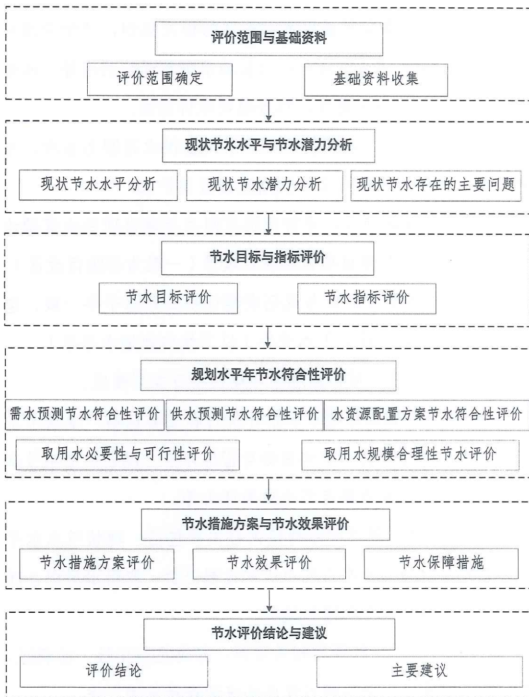
图 1 规划及水利工程项目节水评价技术流程图
